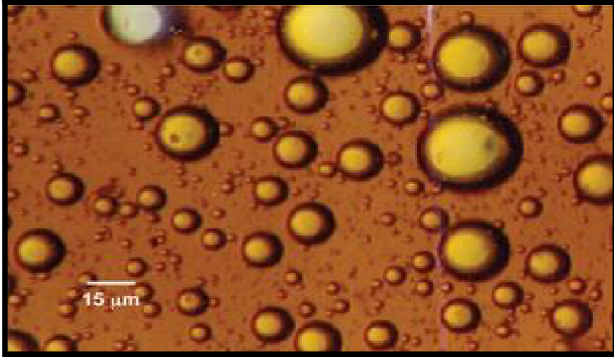
الشكل (1) صورة مجهرية لمستحلب ماء - نפט
