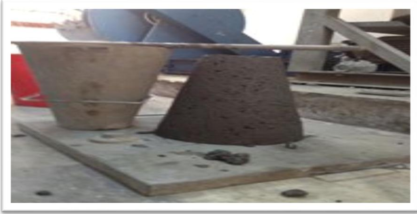
شكل 6 : اختبار الهبوط للخرسانة الطازجة
